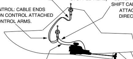
CABLE ENDS FROM LOWER CONTROL ATTACHED TO ENGINE/TRANS.
